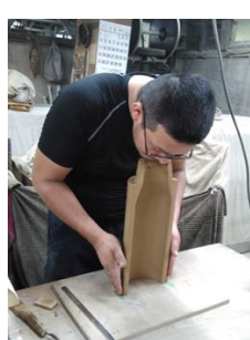
軒丸瓦の製作状況
